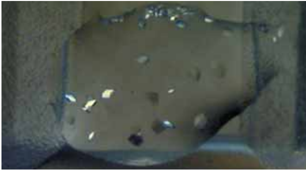
Abbildung 6: Mikroskopische Detektion von Proteinkristallen mit polarisiertem Licht durch AMPLiseal™ hindurch
